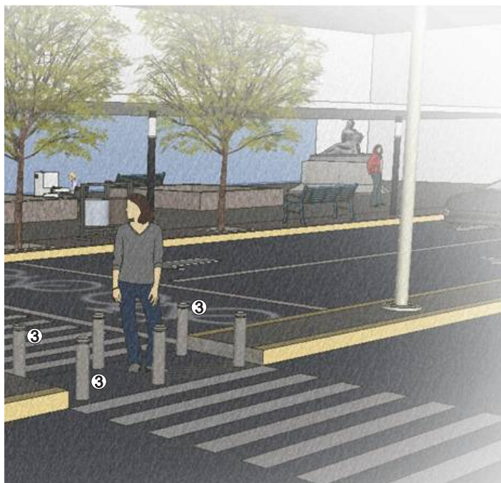
Bolardos sobre cruce peatonal en camellón
