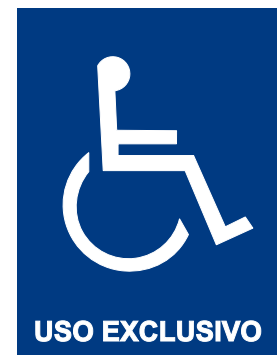
señalización vertical colocar en poste a una altura entre 2.20m y 2.40m.
