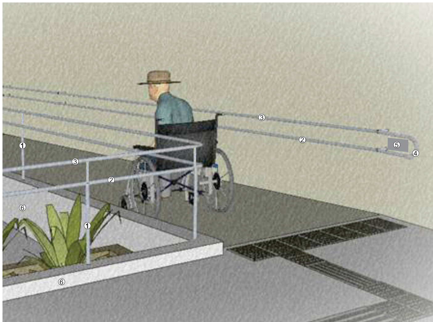
Barandal y pasamanos en rampa
